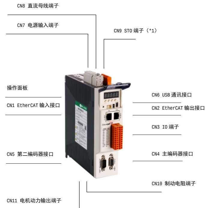
图 4-1-1 驱动端子布局图
