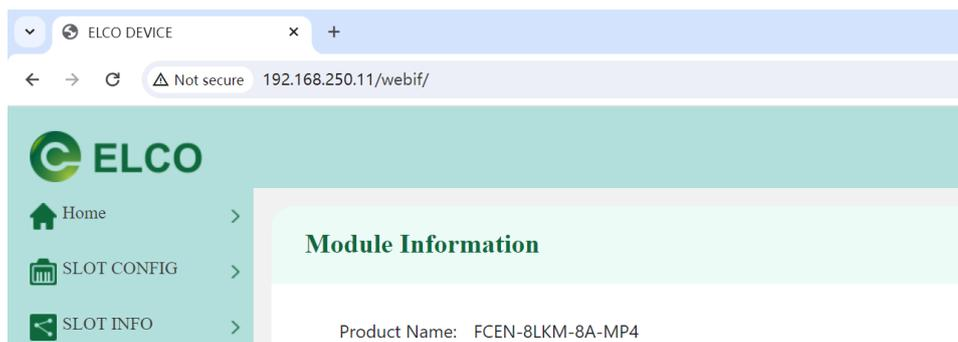
在首页 Home 中即可看到 IP 地址设置的界面，修改 IP 地址和子网掩码的数值，并点击“Set IP”按钮。设置成功后，按钮下方会显示“IP configuration successful, effective after board reboot”提示，重启后新的 IP 地址生效。
